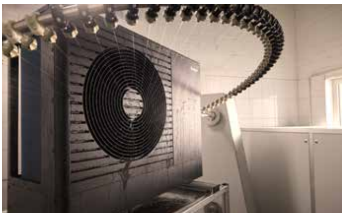
Test de stropire pentru protecție chiar și în condiții de precipitații extreme
